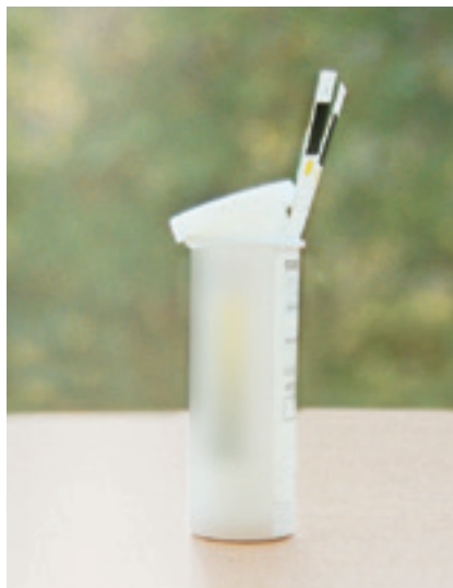
Teststreifen unsachgemäß gelagert
